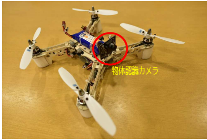
図 1: カメラ画像を通じて物体と相互作用する飛行ロボット
