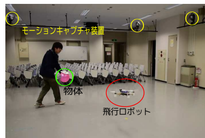
図3: 飛行実験スナップショット. モーションキャプチャー装置 (MoCap) は, 飛行結果の測定に用いた. 自律飛行制御に MoCap は用いていない.
